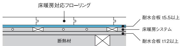
■接着剤（推奨 無垢床ボンド マルチパック:KOAMB-002 積水フーラー株製）は、施工要領書に従って周辺部合板及び床暖房器具の小根太上に直径15~20mm、高さ10mm程度を目安として点状に塗布してください。その際、実部分に接着剤が入らないようにしてください。また、接着剤がフローリングの表面に付着した場合は、すぐに布などで拭き取ってください。水性ボンドは、床鳴りや材の膨張の原因となりますので、ご注意ください。
